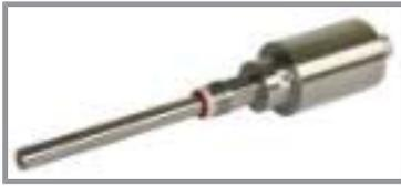
**Люминесцентный датчик растворенного кислорода M1100 предназначен для отслеживания количества кислорода в пиве.**
