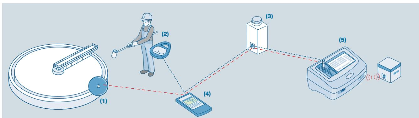
RFID-локатор LOC 100 (4) передает данные, связанные с метками места отбора пробы (1) и оператора (2) на RFID-метку пробы (3). Для переноса данных используются RFID-метки. Спектрофотометр DR 3900 (5) автоматически считывает информацию об образце с его метки (3) – место отбора, оператор, дата, время и т.д.
